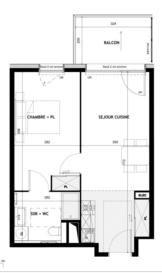
**LEGENDE**: Porte - fenêtre **ELEC** Tableau électrique Fenêtre Cuisson Sèche-serviette Faux-plafond Volet Roulant Tri Allège Vitrée
