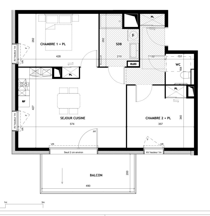
**LEGENDE**: Porte - fenêtre ELEC Tableau électrique Fenêtre Cuisson Sèche-serviette Faux-plafond Volet Roulant Tri Allège Vitrée
